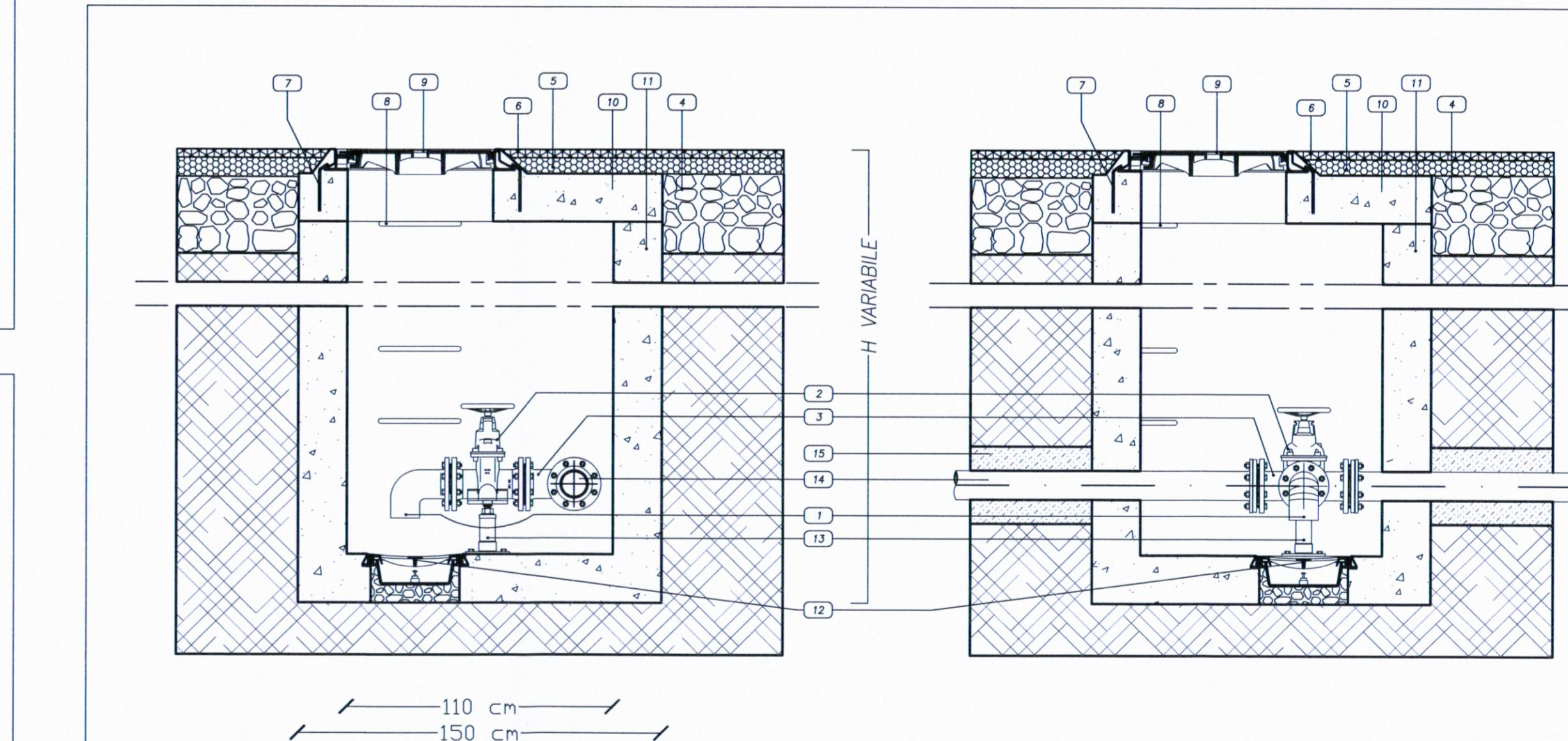
Pozzetto di scarico acquedotto - DN 100
