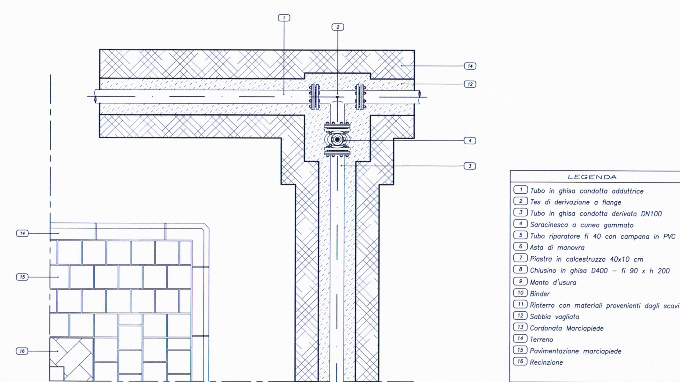
Derivazione da condotta adduttore con saracinesca d'intercettazione sottosuolo
