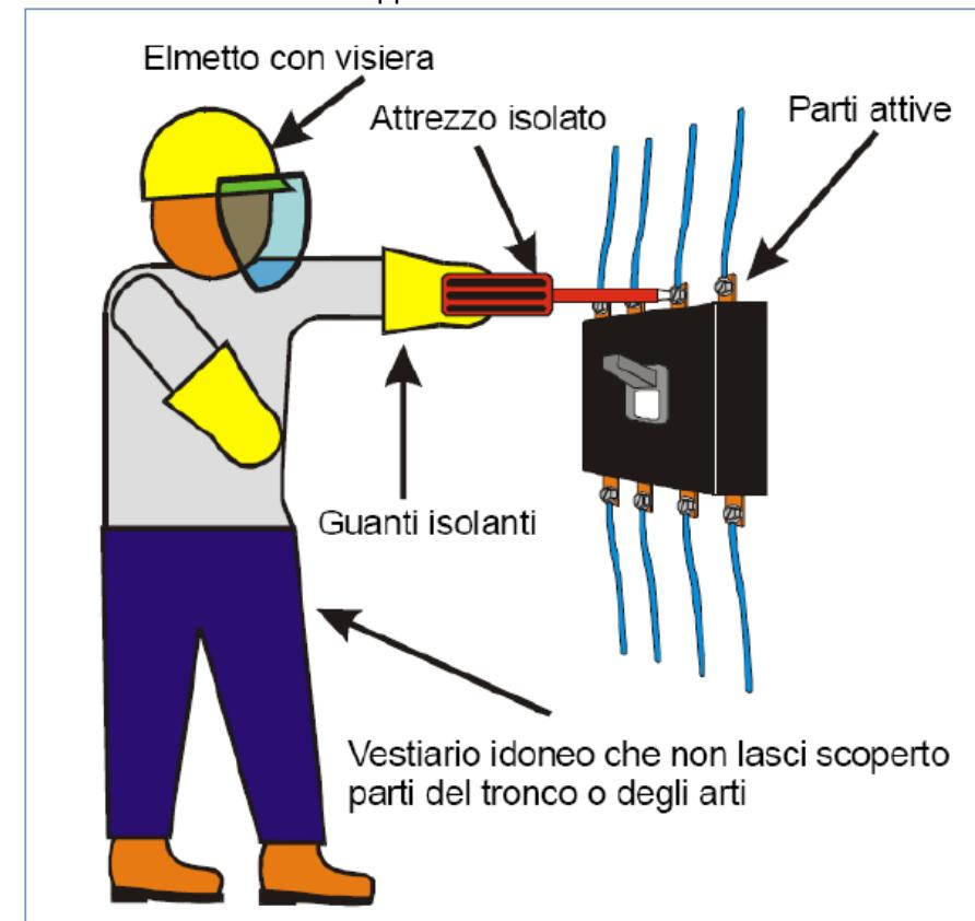
Altra via di protezione dai contatti diretti e la messa fuori servizio degli impianti. Questa procedura puo essere adottata ogni qualvolta non sia necessario l'impianto in tensione. Nel caso di impianto in tensione (quali ricerca guasti), si devono adottare tutte le altre tecniche di protezione ovvero DPI, sorveglianza e personale altamente formato. La messa fuori tensione viene divisa in varie fasi:
