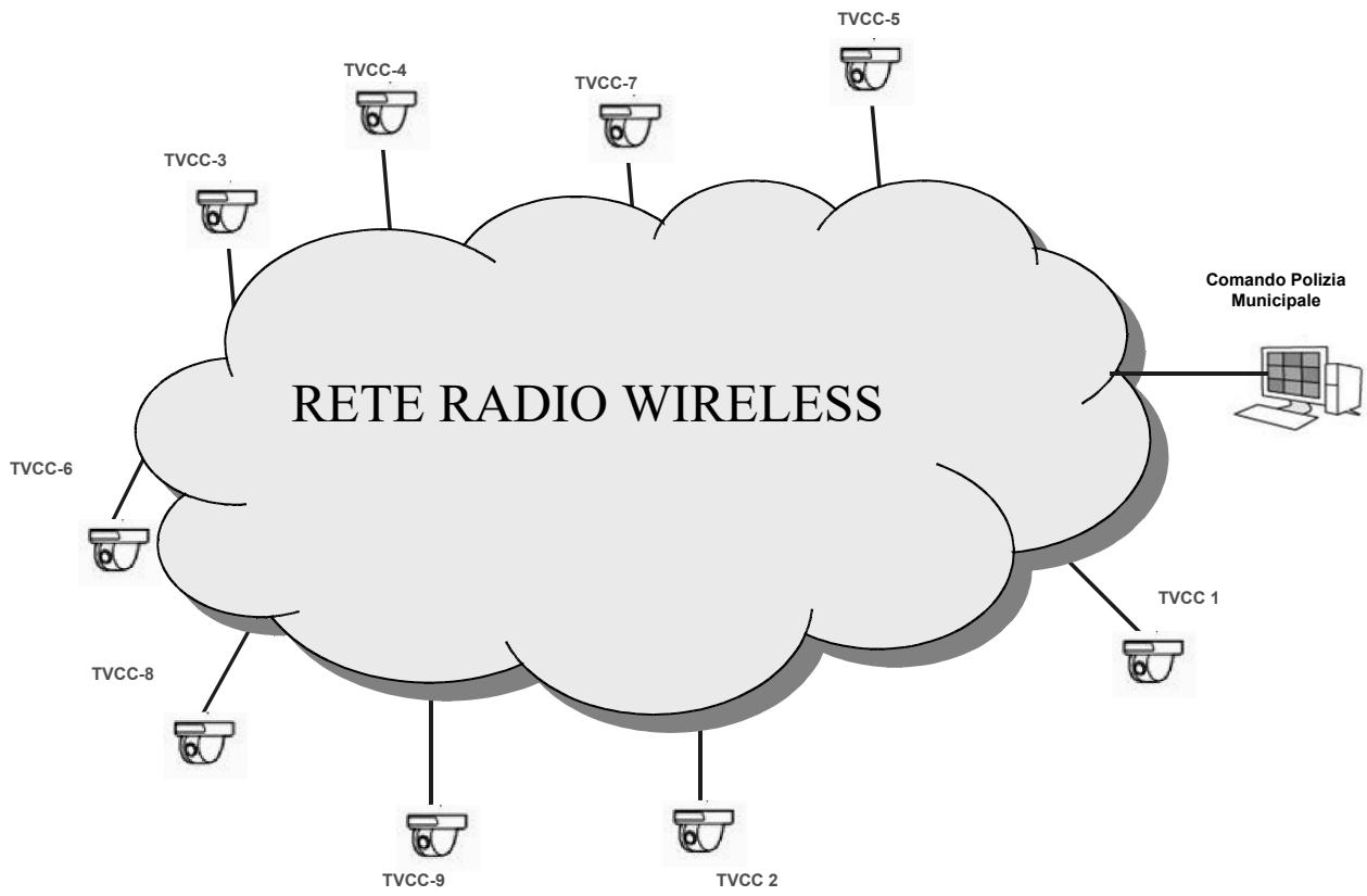
Per realizzare il collegamento fra tutte le postazioni di videoripresa ed il Comando di Polizia, si potranno utilizzare alcune postazioni di proprietà comunale, che per le loro caratteristiche di altezza sul terreno, permettono di essere visibili dalle diverse postazioni di videoripresa.
