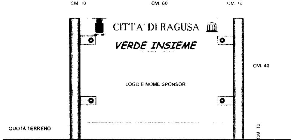
**STRUTTURA DA REALIZZARE CON TUBOLARI IN ACCIAIO SATINATO DIAM. 6 CM**
