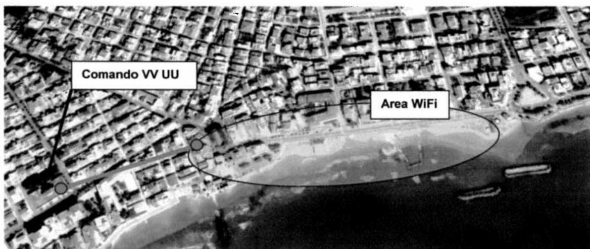
La rete wireless sarà realizzata secondo due livelli topologici, un livello di accesso ed un livello di distribuzione, e realizzati con tecnologia radio operante su frequenze non licenziate 2,4Ghz per il livello di accesso e 5,4Ghz per il livello di distribuzione.
