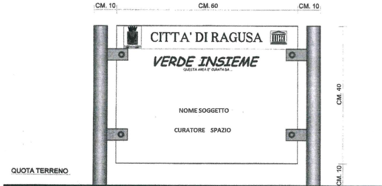
**STRUTTURA DA REALIZZARE CON TUBOLARI IN ACCIAIO SATINATO Ø 6 cm.**
