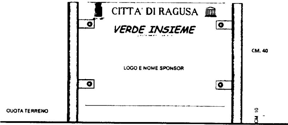
**STRUTTURA DA REALIZZARE CON TUBOLARI IN ACCIAIO SATINATO DIAM. 6 CM
