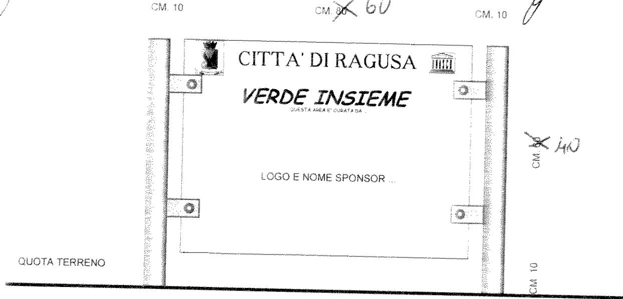
STRUTTURA DA REALIZZARE CON TUBOLARI IN ACCIAIO SATINATO Ø 6 cm.
