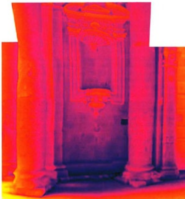
Fig. 14 - Noto (SR), Chiesa di San Lorenzo. Dall'immagine termica si evidenzia il gradiente termico dalla parte bassa della muratura fino a sfumare.
