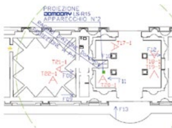
Fig.8 - Palazzo Te, Mantova - Schema planimetrico con ubicazione prove (termografie IR e foto del degrado superficiale) e foto installazione apparecchi Domodry®.
