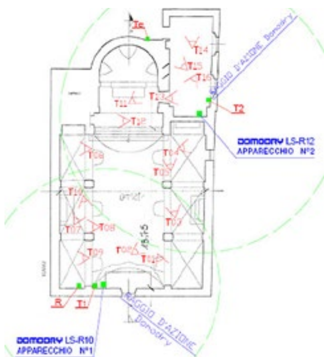
Fig. 42 - Schema dell'impianto Domodry con ubicazione in pianta delle prove effettuate (termografie all'infrarosso) e delle sonde per il telecontrollo dei parametri microclimatici.
