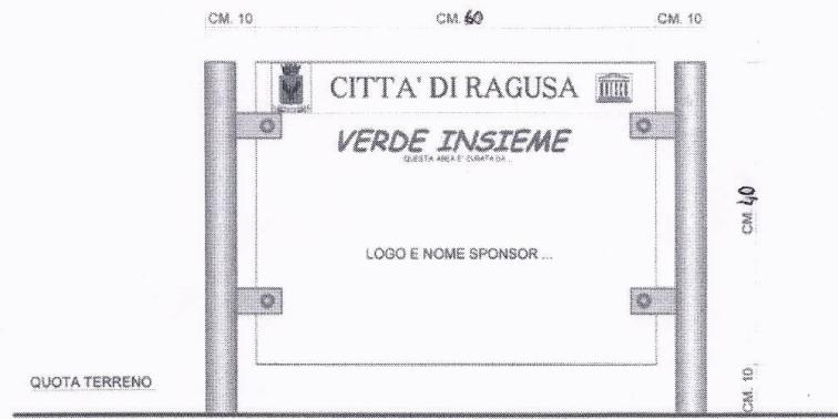
STRUTTURA DA REALIZZARE CON TUBOLARI IN ACCIAIO SATINATO DIAM. 6 CM
