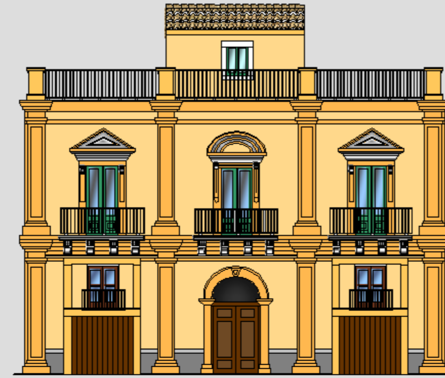
TERRAZZO E CORPO IN ELEVAZIONE NON STORICIZZATI IN SOSTITUZIONE DI COPERTURA A TETTO, ALTERAZIONE COMPOSITIVA ED ARCHITETTONICA DELL'ORIGINARIA CONFIGURAZIONE DELLA FACCIATA AL PIANO TERRA (STORICIZZATA)
