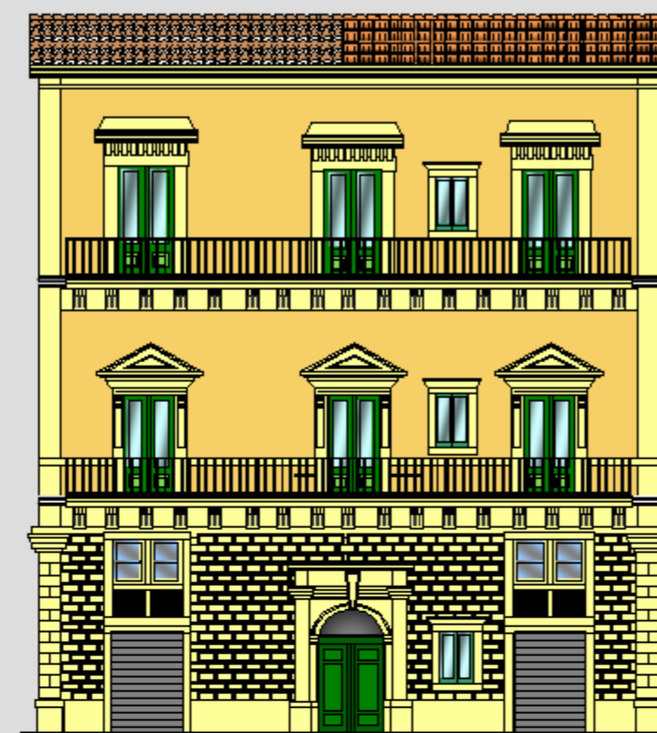
MANTO DI COPERTURA REALIZZATO PARTE CON COPPI DI PRODUZIONE INDUSTRIALE A VISTA INTONACO ED ELEMENTI LAPIDEI TINTI E GLIATI CON VERNICE COPRENTE . SARACINESCHE IN LAMIERA NON VERNICIATA , INSERIMENTO APERTURE CON ALTERAZIONE SIMMETRIA DELL'ORIGINARIO SCHEMA COMPOSITIVO .
