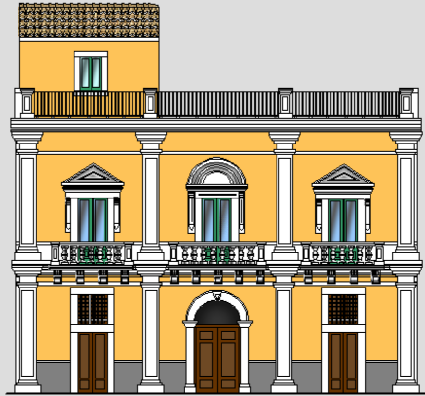
TERRAZZO E CORPO IN ELEVAZIONE NON STORICIZZATI N SOSTITUZIONE DI COPERTURA A TETTO
